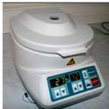
Fig. 2.75 – Photo d'une centrifugeuse [142]
