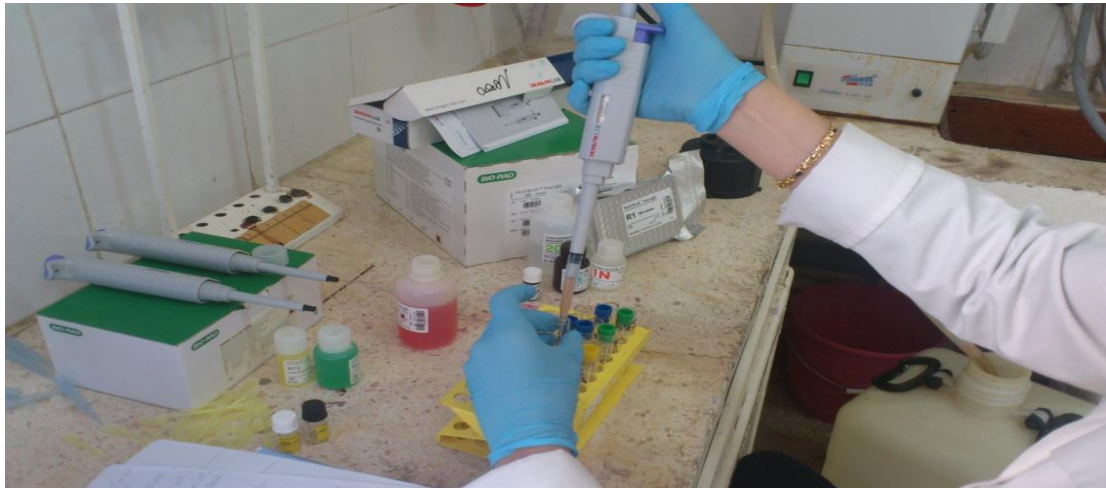
Figure 29. Photo des dilutions des calibrateurs et des sérums.
