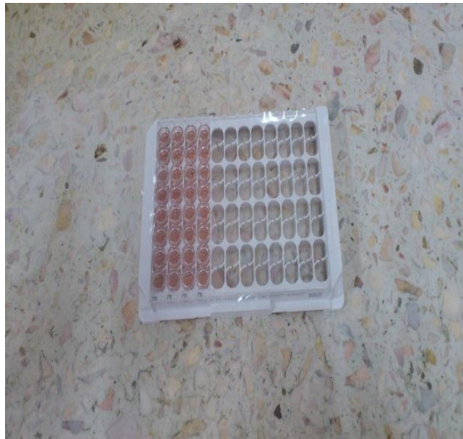
Figure 31. Photo de la microplaque couverte d'un film adhésif.
