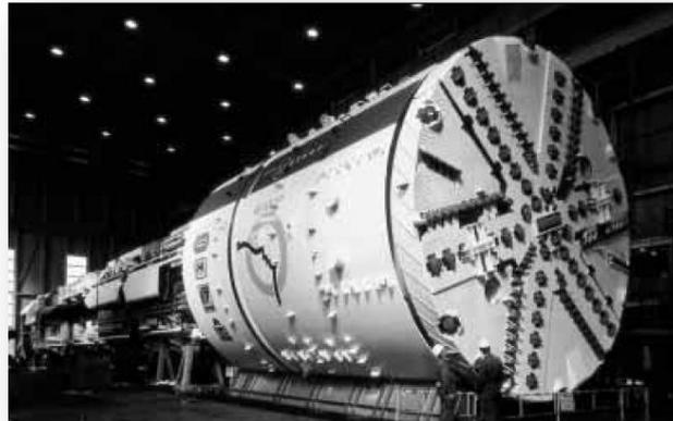
**Fig. 1.11** Bouclier à pression de boue (Chantier METEOR à Paris) (CETU, 2005)
