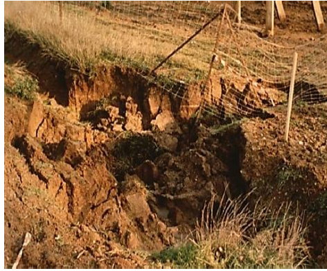
Photo 3.1: Troubles aboutis à partir d'excavation soumises aux précipitations.
