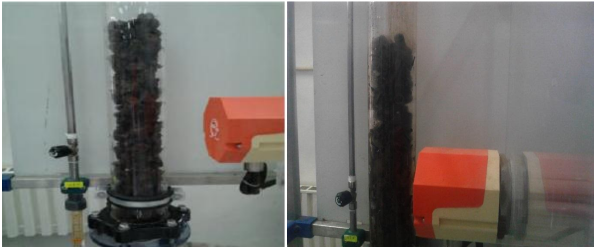
Figure III.6. Schéma d'une cartouche remplie par le garnissage en pouzzolane et aussi par garnissage plastique ; (laboratoire du département d'hydraulique université de Tlemcen).
