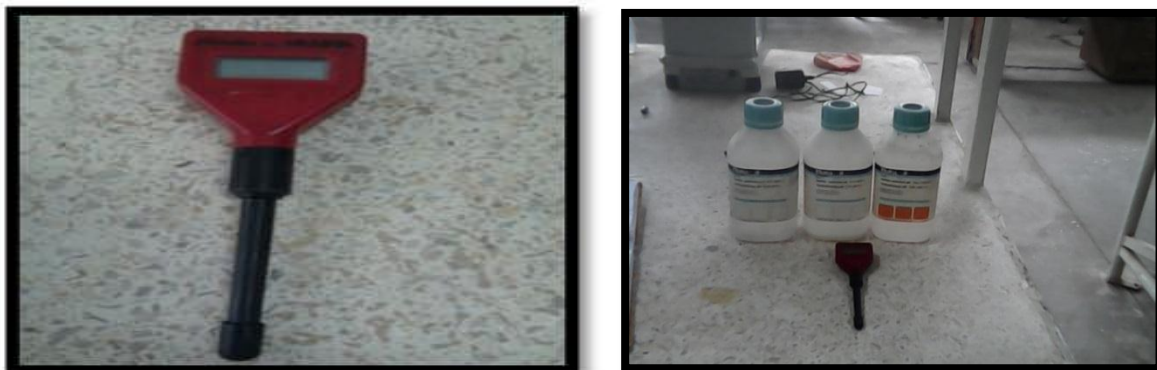
Figure III.8 : pH mètre (manuel) et les solutions tampon (laboratoire du département d'hydraulique université de Tlemcen).
