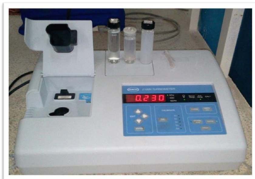
Figure III.10: Turbidimètre de Laboratoire d'Hydraulique. Université de Tlemcen.
