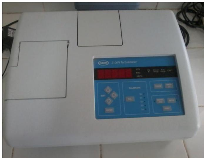
**Figure III.2:** Photo du turbidimètre Hatch utilisé
