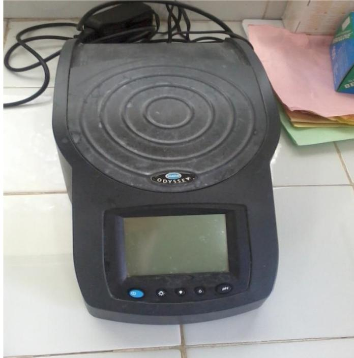
**Figure III.3 :** Photo du photomètre Hach utilisé
