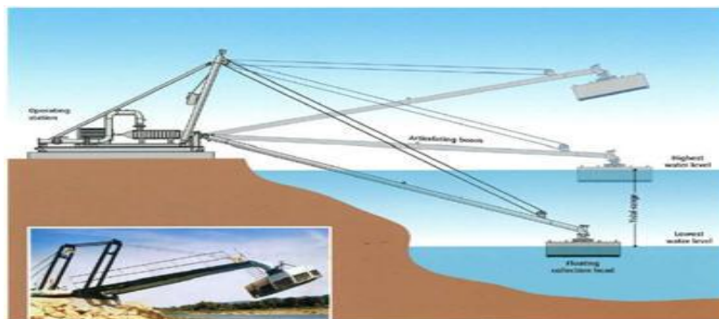
Figure I.6 : Prise d'eau mobile [C]
