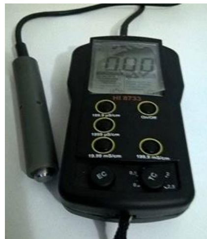
Figure III.28 : Conductimètre (Laboratoire TTE, Dprt Hydraulique, Université Tlemcen)
