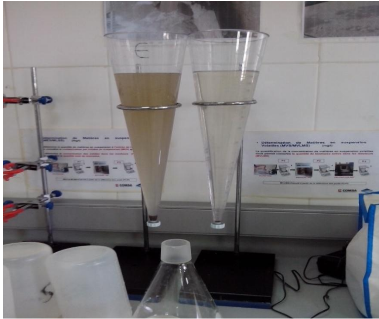
Figure IV .11: test de décantation
