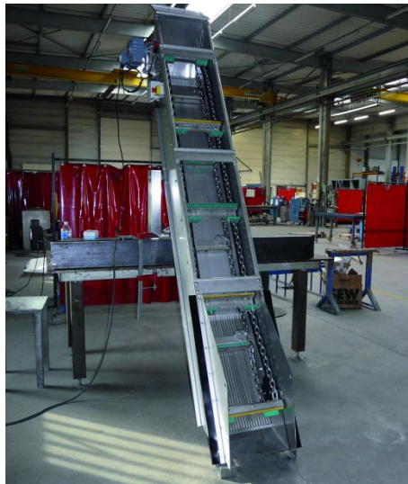
Figure V.2 : Photo du dégrilleur mécanique type DEI .Inofilter
