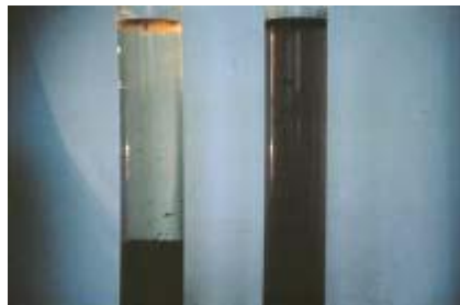
Figure II.14 : Tests en éprouvettes – présence de flottants [10]
