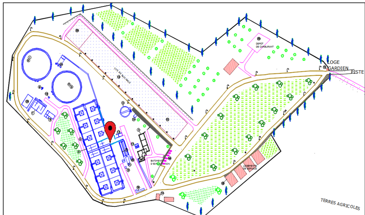
Figure V.13: Situation des points d'injection des substances léstants et coagulants
