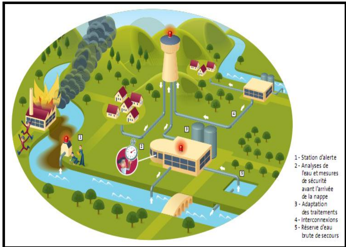
Figure 2-20: Evaluation des risques de pollutions accidentelles et mettre en place des dispositifs de sécurité (Veolia eau, 2006).
