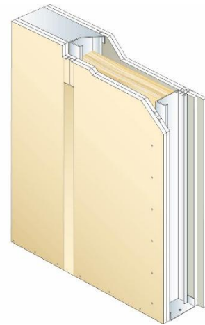
Figure 173: schéma d'une cloison séparative simple parement
