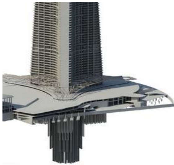
Figure 144: système de frottement des pieux
