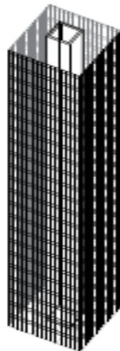
Figure 70: système du tube dans le tube (schéma) 75
