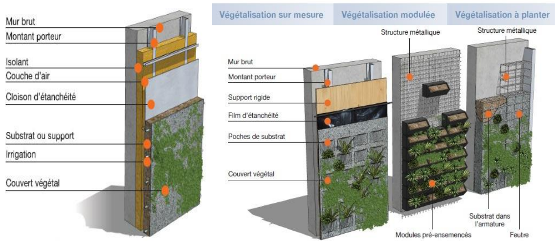
Figure 59: la technique de la facade végétalisée. 142
