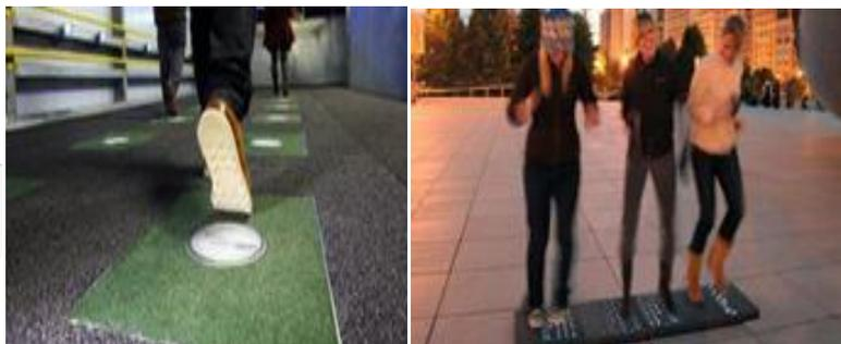
Figure 108:pavé générateur d'énergie
