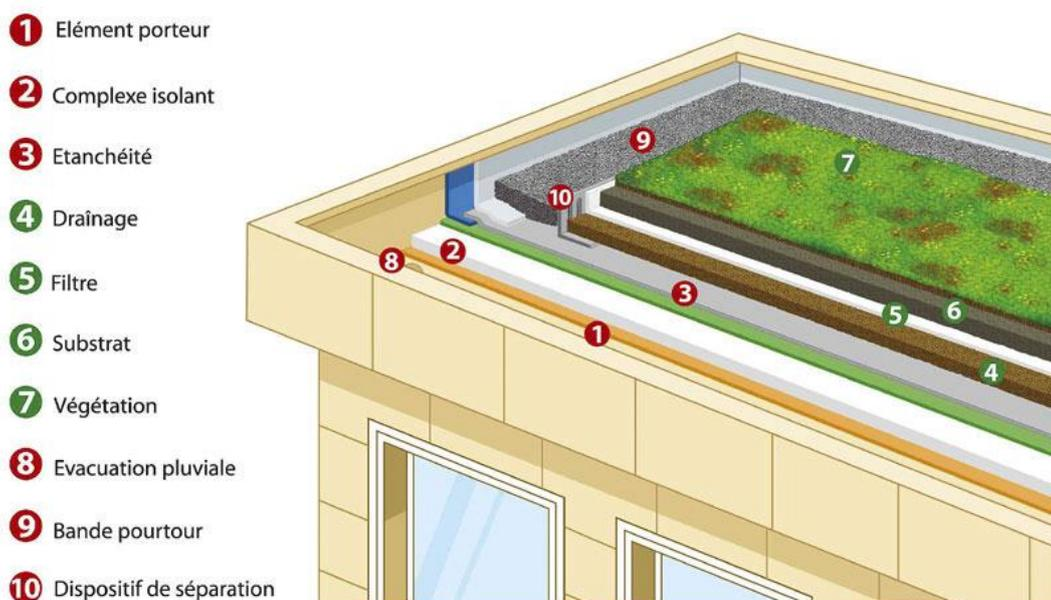
Figure 107: Les éléments d'une toiture végétalisée
