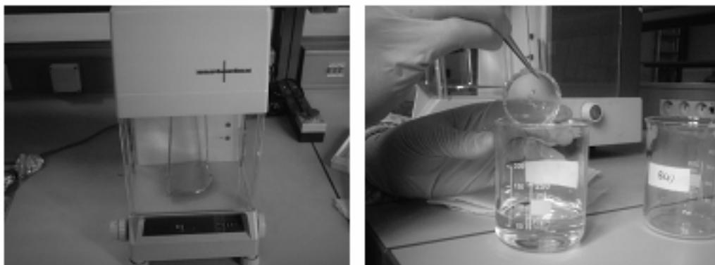
**Figure (II.3)** : Dispositif utilisé pour l'étude du gonflement des réseaux interpénétrés de polymères dans différents solvants.
