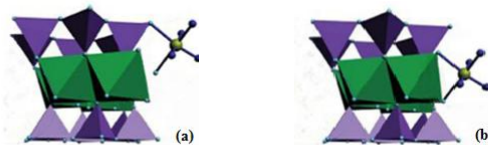
Figure 57: mécanisme d'adsorption de \text{Cr}^{3+}/\text{Ni}^{2+} sur la surface de la bentonite sodique : (a) sur les sites tétraédriques, (b) sur les sites octaédriques.
