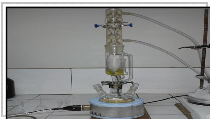
**Figure 10** : Le montage de soxhlet
