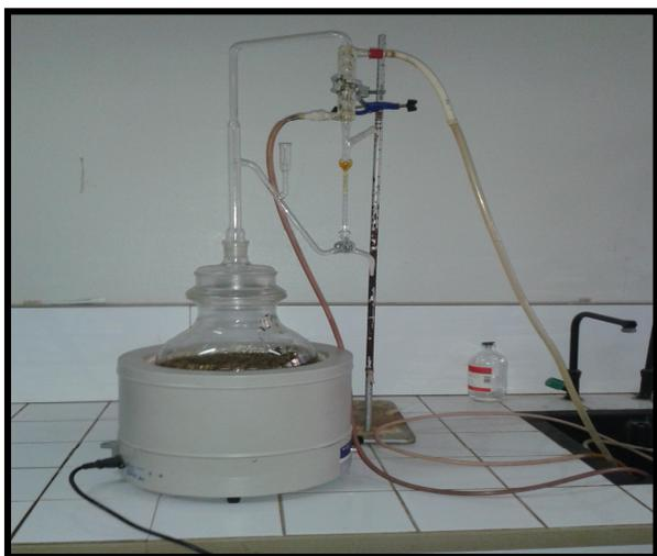
**Figure 8 :** Le montage de l'hydrodistillation
