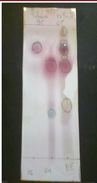
**Figure 3.17** : CCM. A droite : l'huile essentielle du clou de girofle, au milieu : l'eugénol, et à gauche : l'acétate d'eugényle.  $R_f$  acétate d'eugénol = 0.94 ;  $R_f$  eugénol = 0.66.
