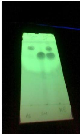
**Figure 3.16** : CCM. A droite : l'huile essentielle du clou de girofle, au milieu : l'eugénol, et à gauche : l'acétate d'eugényle.  $R_f$  acétate d'eugénol = 0.94 ;  $R_f$  eugénol = 0.66.
