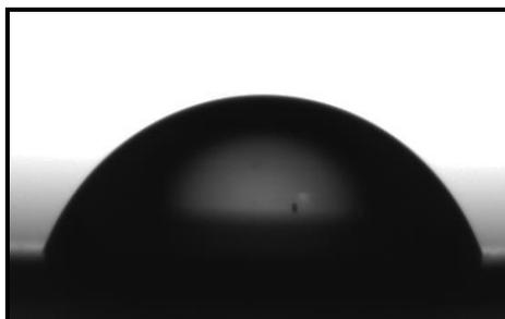
*Figure II-20 : Photographie d'une goutte d'eau ( $3\mu\text{L}$ ) déposée sur la surface de Si après la réaction d'activation.*
