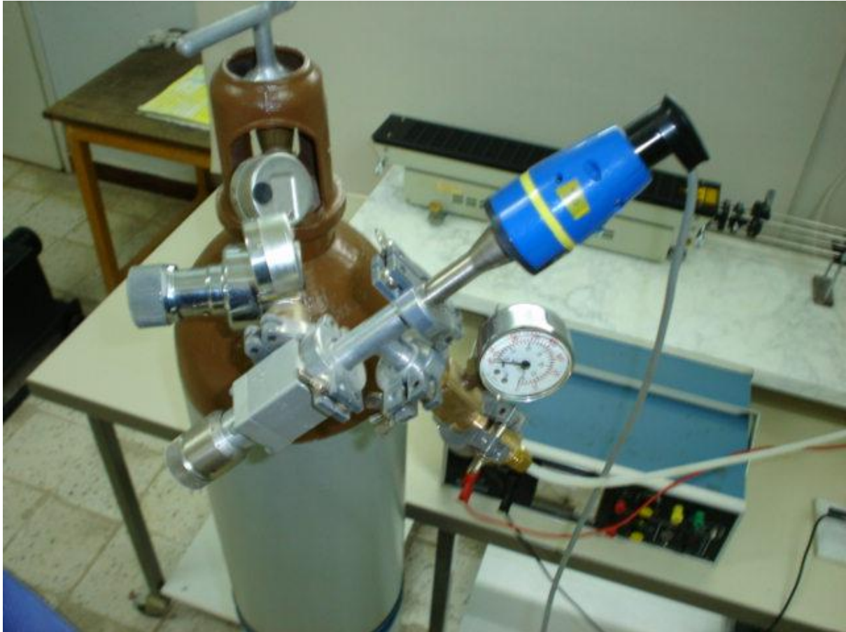
Photo n °10 : vue de la vanne et de la jauge pirani qui peut aller jusqu'à 10^{-2} mb (laboratoire d'optique - Université de Tlemcen).
