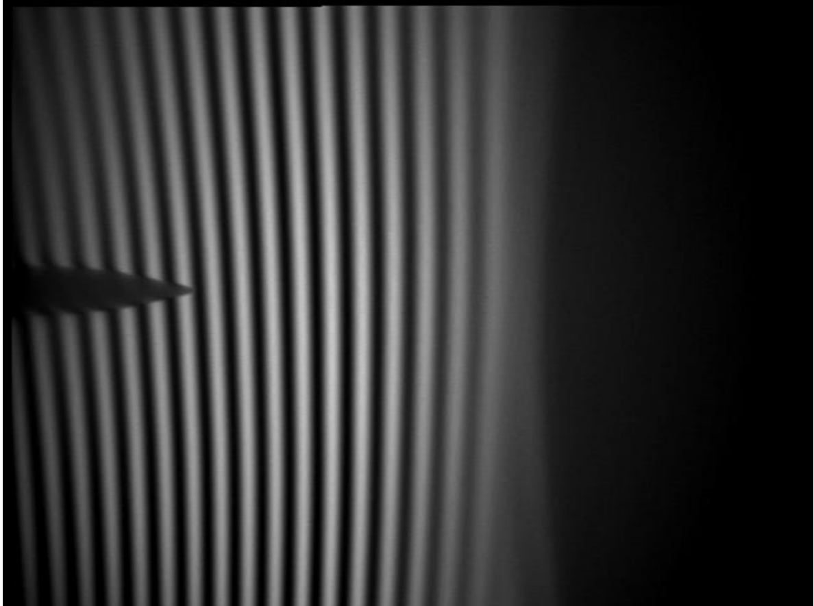
Photo n° 16 : réglage du plan d'interférence sur la pointe en lumière spatialement cohérente (Laboratoire d'optique -Université de Tlemcen).
