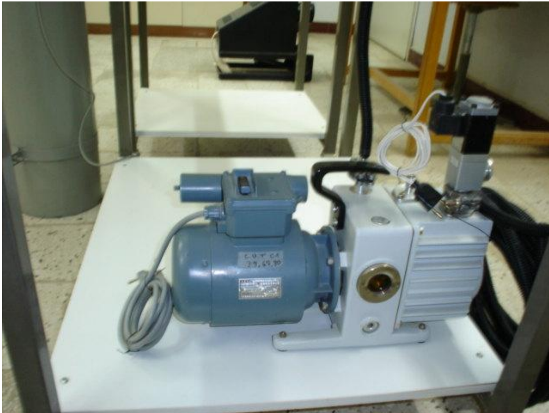
Photo n °8 : vue du groupe de pompage et son dispositif de mesure de pression (laboratoire d'optique - Université de Tlemcen).
