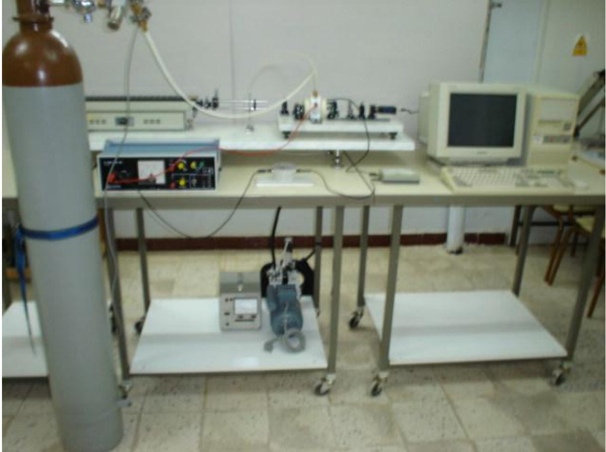
Photo n ° 9 : vue d'ensemble du dispositif interférométrique Mach-Zehnder avec le groupe pompe à vide, la bouteille à gaz et le micro-ordinateur pression (laboratoire d'optique - Université de Tlemcen).
