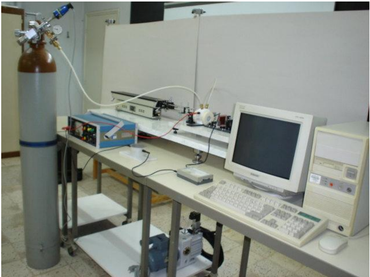
Photo n°1 : vue d'ensemble du dispositif interférométrique Mach-Zehnder avec le groupe pompe à vide, bouteille à gaz et le micro-ordinateur (Laboratoire d'optique - Université de Tlemcen).
