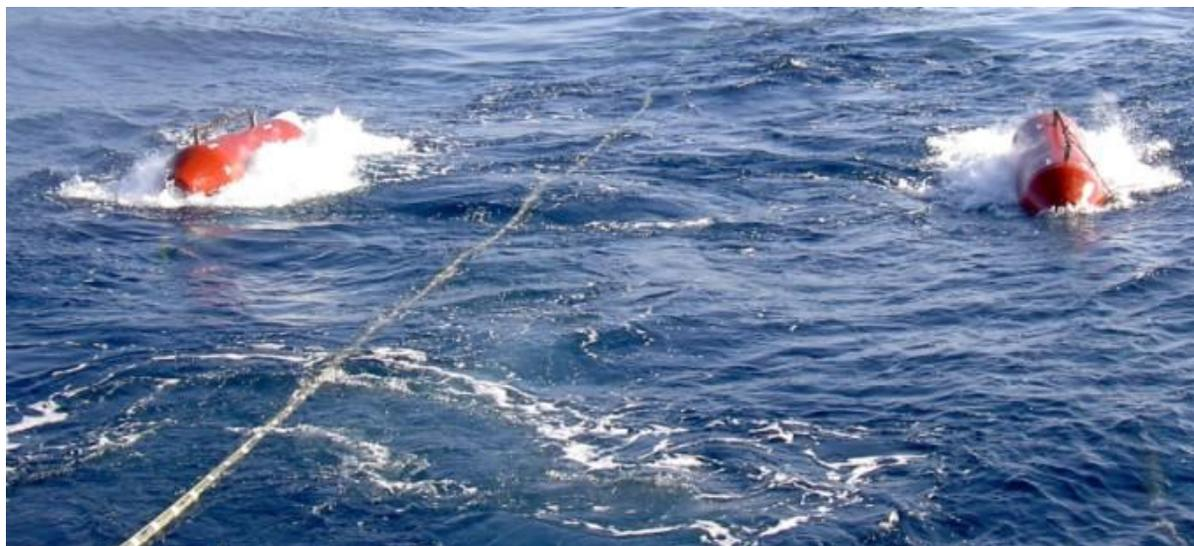
*Fig. 7: Dispositif d'acquisition sismique en offshore (flute et canons à air)*
