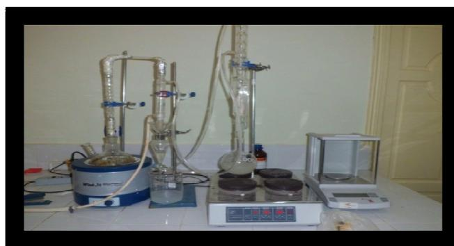
**Figure 6:** le montage d'hydrodistillation employé pour l'extraction des HE (Photo originale).
