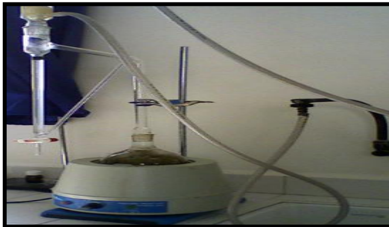
Figure5: le montage d'hydrodistillation employé pour l'extraction des HES
