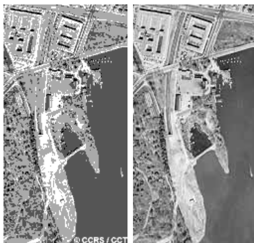
Figure 25 : Comparaison entre image de 2-bits à une image de 8-bits d'une même scène
