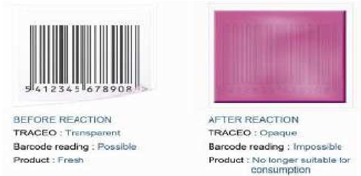
Figure(11) : Indicateur à base de croissance de microorganismes
