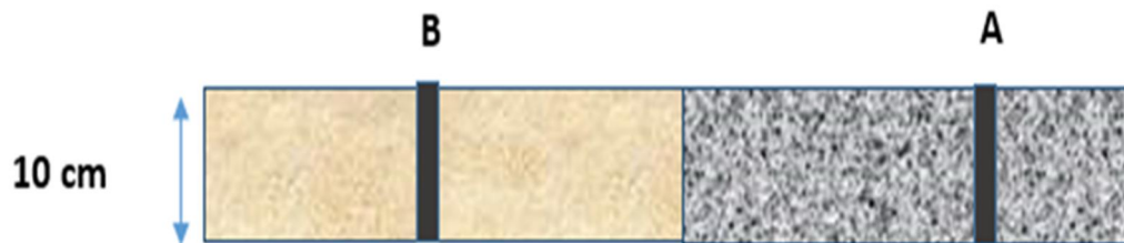
Fig.IV.1: Disposition du matériau aquifère dans le banc (Sable-Gravier).
