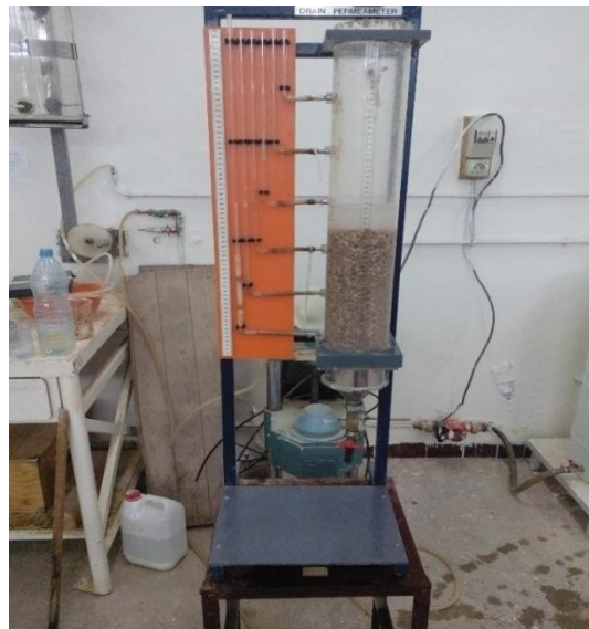
Fig.III.8: Perméamètre à charge constante. (Laboratoire d'Hydraulique, Univ. Tlemcen)
