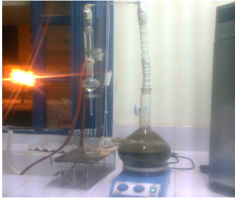
Figure 08 : le montage d'hydro-distillation employé pour l'extraction des huiles essentielles (photo originale)
