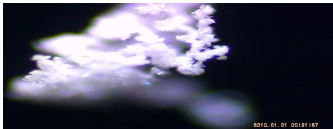
**Figure 24 :** La poudre cristalline obtenue de MOF-5 à température ambiante.
