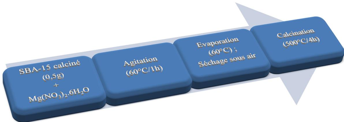
Figure II.2 : Protocole de synthèse de MgO/SBA-15<sub>n</sub> par post-synthèse.
