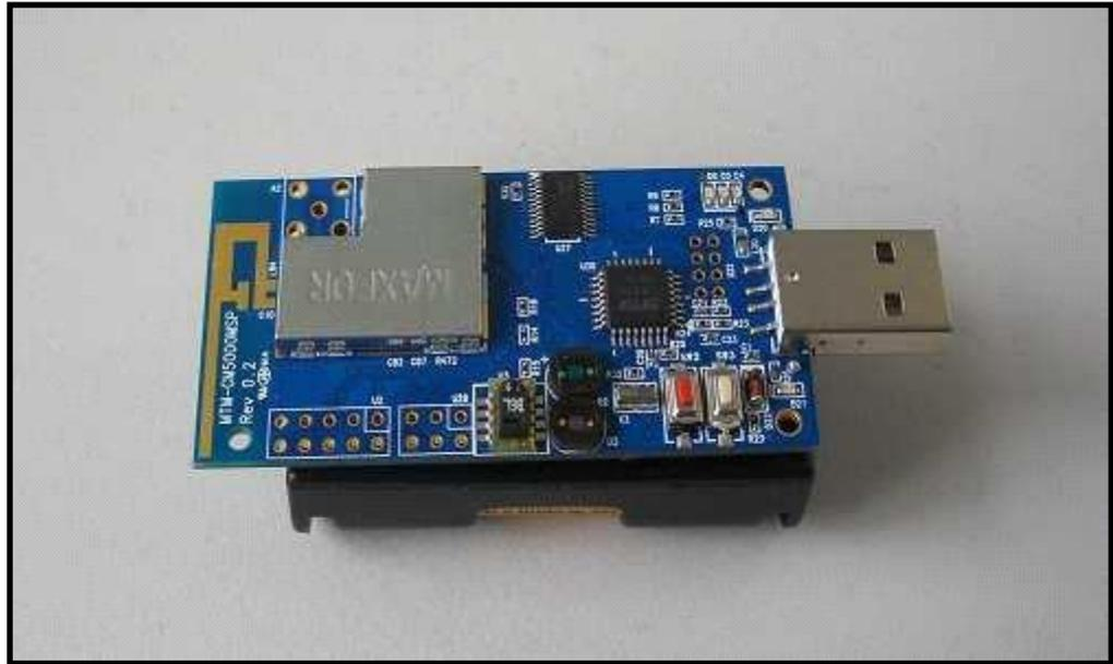
**Figure 11: Un capteur TelosB**
