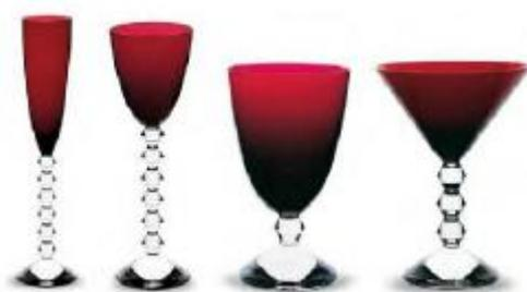
**Figure 1.6 :** Verres de couleur «Rubis » de la collection Véga chez Baccarat, couleur obtenue par incorporation de nanoparticules d'or dans la matrice vitreuse. [4]
