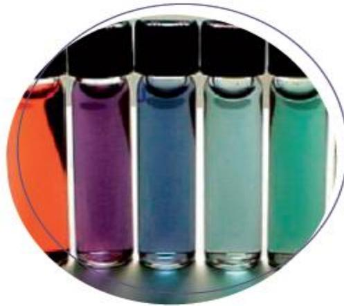
**Figure2.3 :** Couleurs d'une série de nanobâtonnets d'or de tailles différent. [24]
