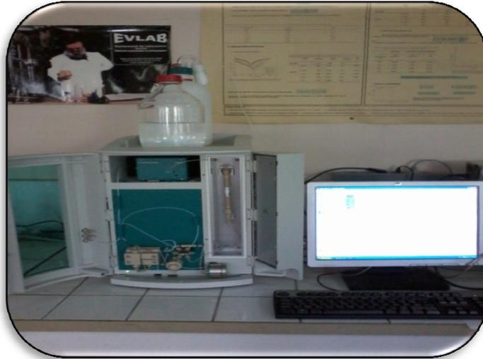
**Figure II-1 :** Chromatographe ionique model (881 Compact IC pro) utilisé.
