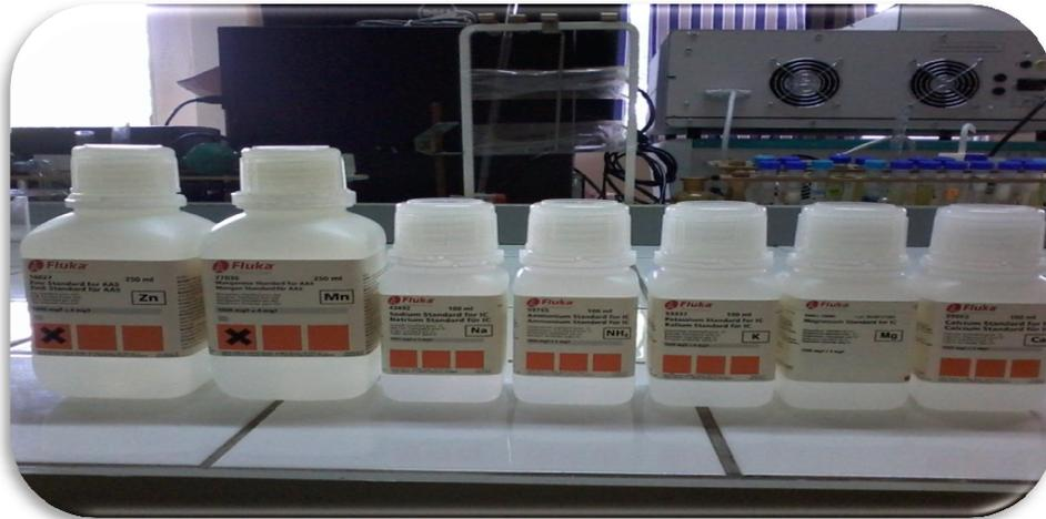
**Figure II-6:** les étalons commerciaux pour l'analyse des cations.
