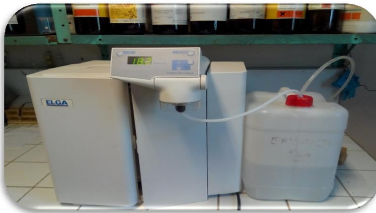
**Figure II-5:** appareil de production d'eau ultra pure utilisée
