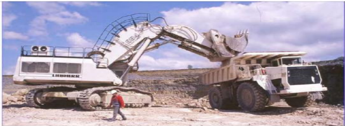
Figure I.7: Transport par dumpers [24].
