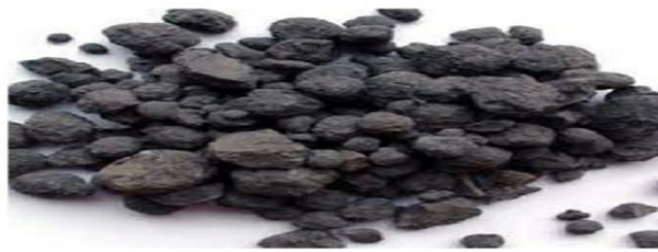
Figure I.2 : Nodules de clinker de Béni-Saf de taille environ 20 mm.
