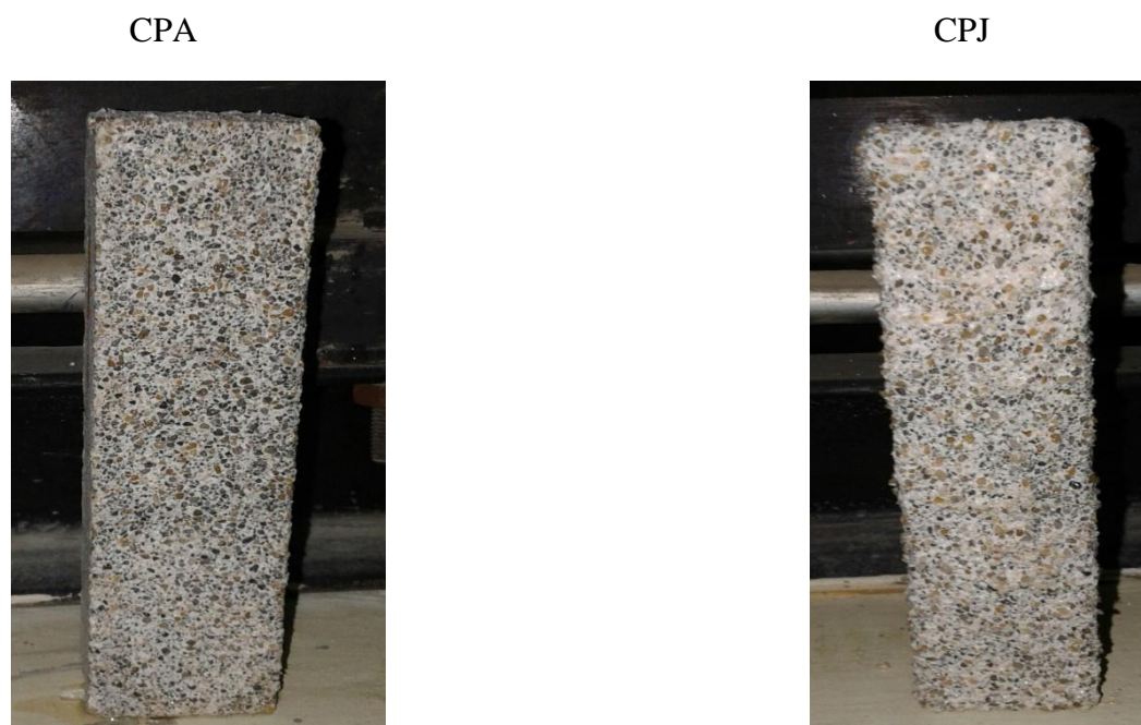
Figure IV.7 : Etat d'éprouvette après immersion de 28 jours dans l'eau potable.
