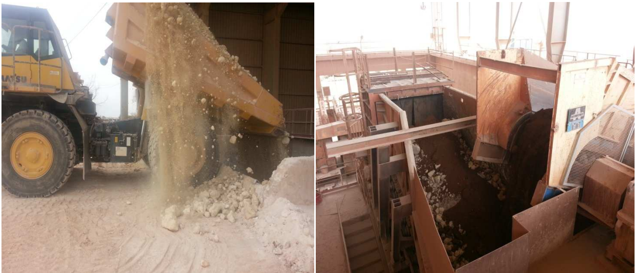
Figure I.4: Concassage des matières premières au niveau de la carrière.
