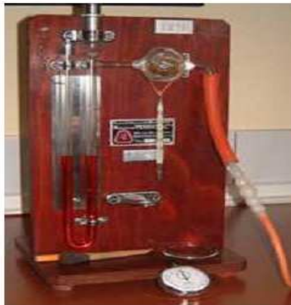
Figure II.4: Principe de fonctionnement de perméabilimètre de Blaine [5]
