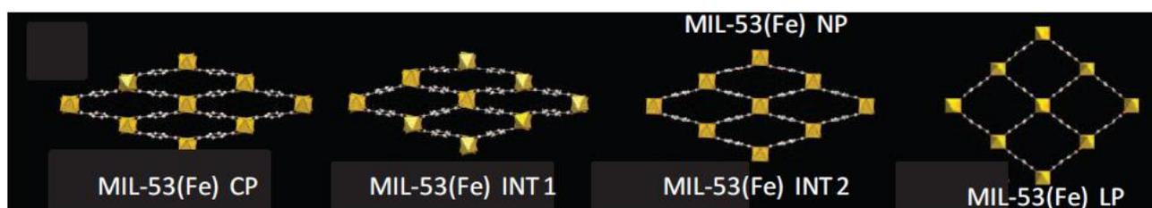
Figure I 18: Les différentes phases identifiées pour le MIL-53(Fe). En présence d'eau dans ses pores la phase INT1 est observée qui se transforme en CP par chauffage à 150°C. En présence de molécules hôtes les phases LP, INT2(ou NP) sont observées.
