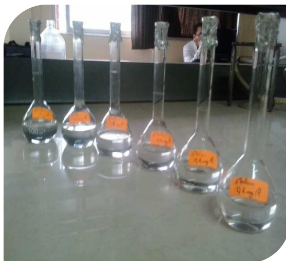
Figure II-11: Ensemble des solutions d'étalons pour l'analyse simultanée des éléments majeurs et des éléments mineurs.
