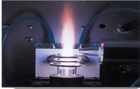
Figure 05 : photographie d'un plasma d'argon.
