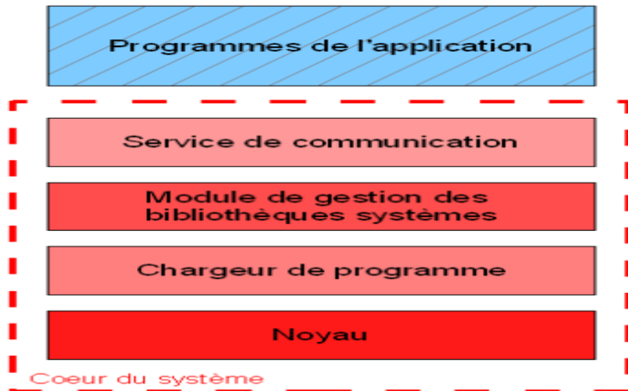
Figure II. 1 : Architecture du système Contiki [15].
