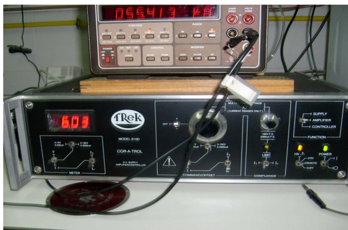
Figure II.5. Générateur électrique utilisé « Trek Model 610 E »
