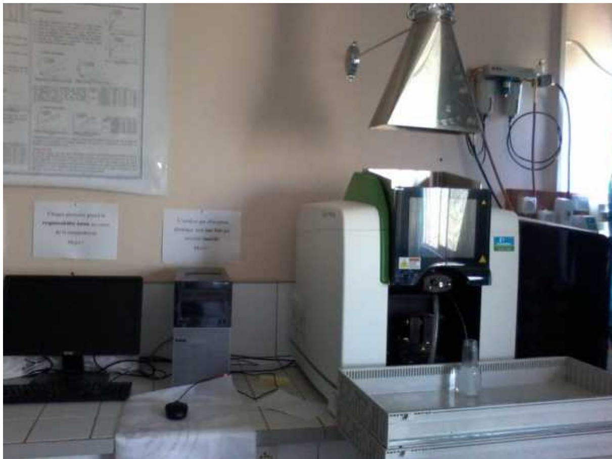
**Photographie III.1** : Spectromètre d'absorption atomique
