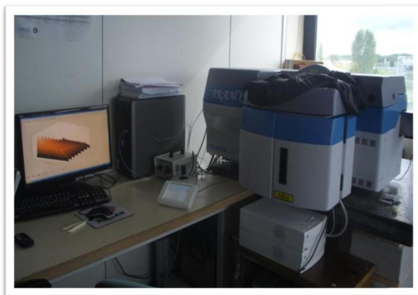
**Figure II.6** La spectroscopie Raman; (LMOPS)-Université de Lorraine & Supélec.
