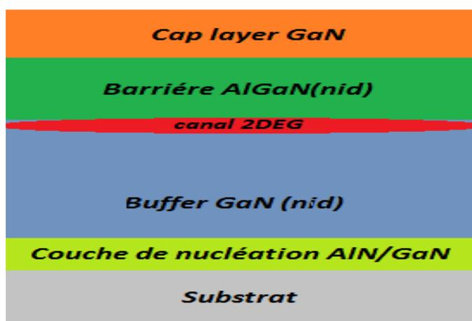
Figure. 1. Structure typique d'un transistor HEMT AlGaN/GaN
