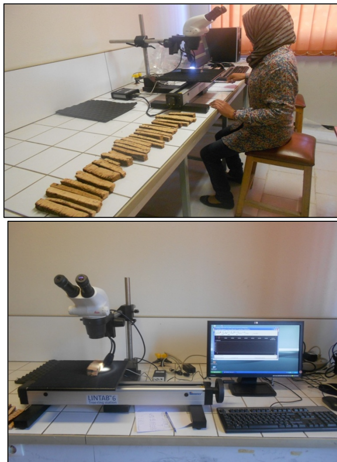
Figure 25: Méthode de mesures des accroissements annuels sous la loupe binoculaire Leica (Original)
