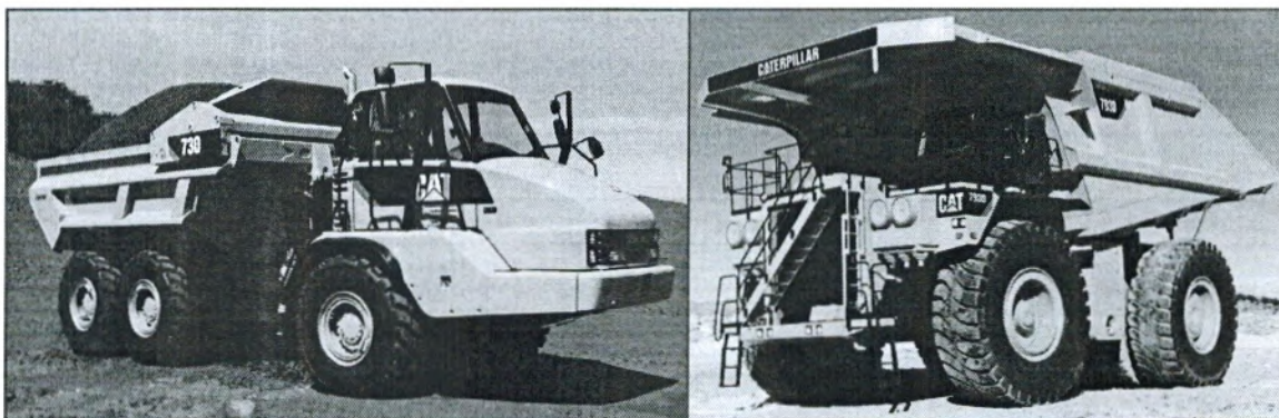
Figure 21 : engins de transport : à gauche camion articulé, à droite dumper.
