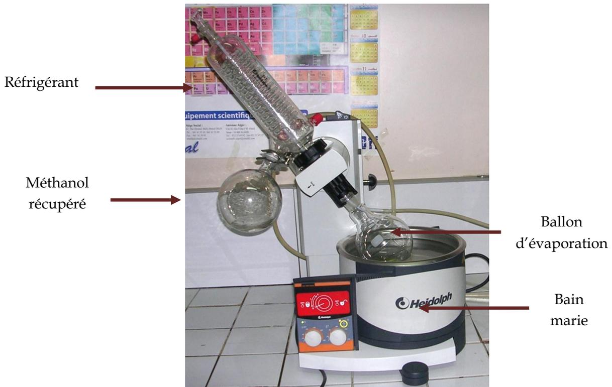
Figure 08: Evaporation a sec par le retavapor.
