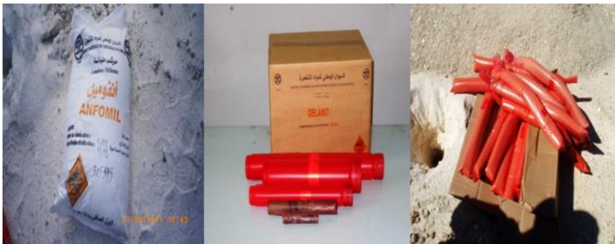
Fig.18 : Différents types d'explosifs (de gauche à droite : Anfomil, Gélانيت et Marmanit)
