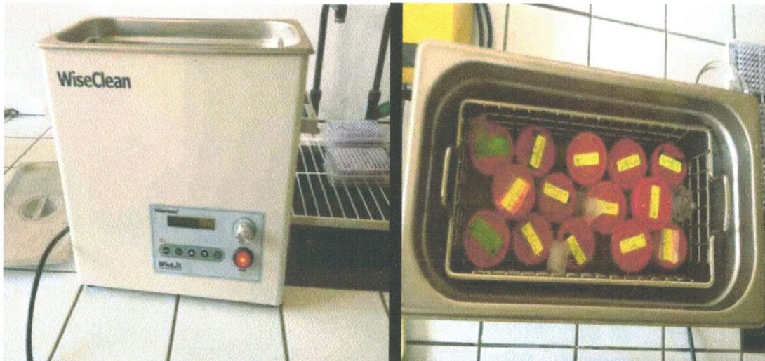
Figure 2.10: Appareil ultra sonique WiseClean      Figure 2.11 : solutions dans le bain glacé
