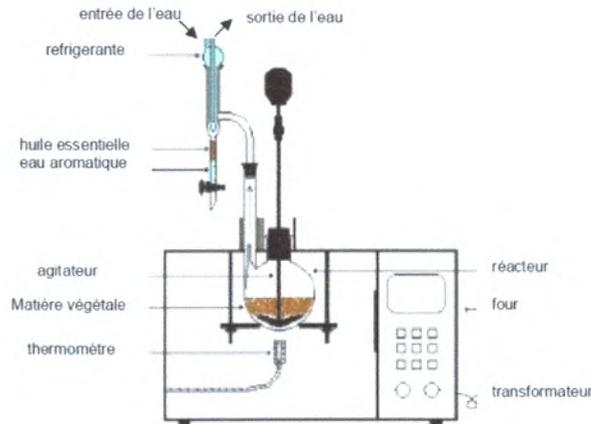
**Figure 11** : Principe schématisé de l'appareillage d'hydrodistillation sous micro-ondes (**Lagunez-Rivera, 2006**)
