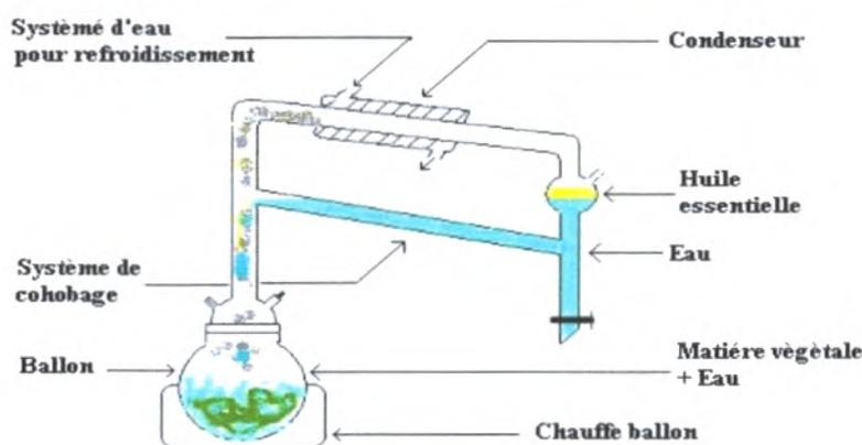
**Figure 10** : Appareillage utilisé pour l'hydrodistillation des huiles essentielles
