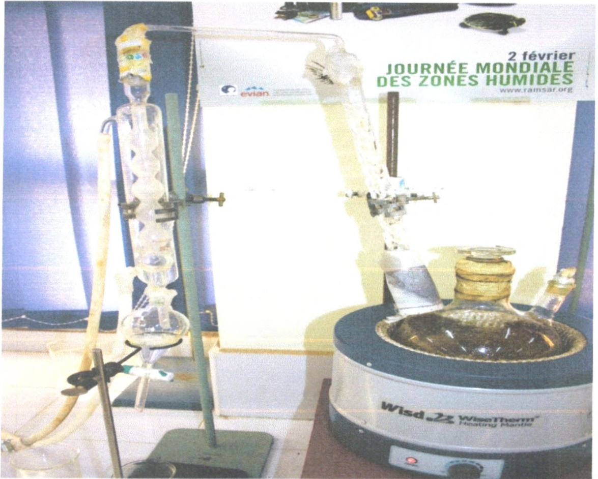
Photo 04: Montage pour l'hydrodistillation « laboratoire N°4 d'Agronomie» (Original)
